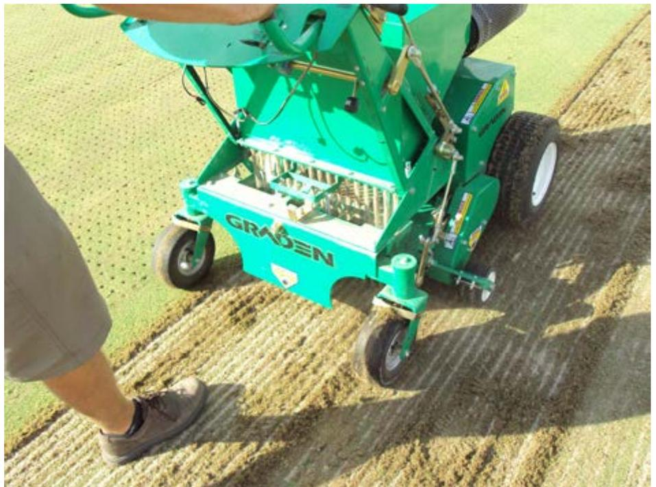
Graden® Contour 注沙机在垂直剪草的同时，还能将沙子回填至通道。该机器能有效去除和稀释表面附近的有机物，但恢复时间可能很长。
