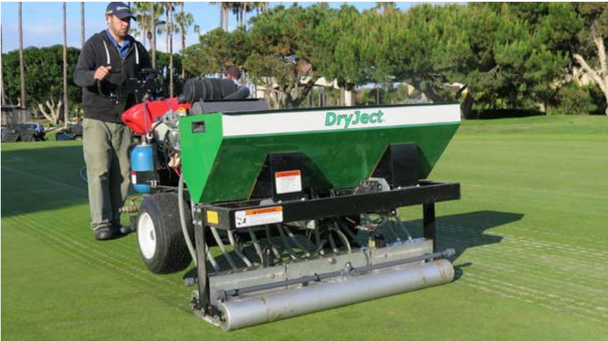
DryJect® 机器可将大量沙子注入根系层土壤，同时不会对练习表面造成太大破坏。但是，该过程无法去除有机物，不可用来代替打孔通气。
